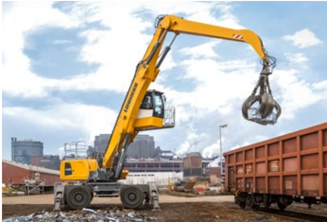
Carga en vagones de paquetes de aluminio prensados con la LH 50 M Industry Litronic
