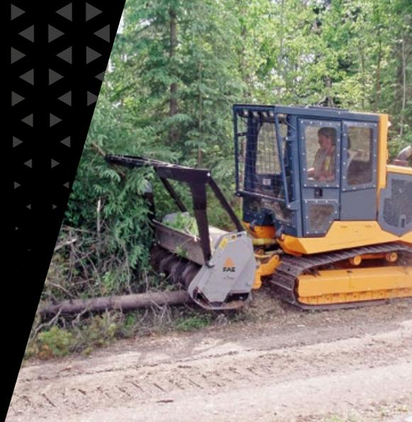
Estructura de empuje mecánica o hidráulica
