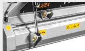
**Compuerta de trituración frontal hidráulica** permite una excelente trituración y reduce la proyección del material triturado
