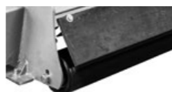
Rodillo posterior con dispositivo de auto limpieza
