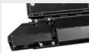
**Cuchilla dosificadora** para nivelar el material triturado
