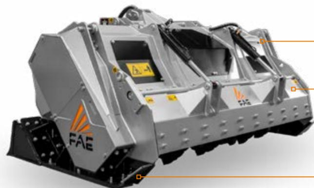
**Estructura y cuerpo interno antipolvo** para proteger la transmisión de la máquina (STCM - STCM/HP)
