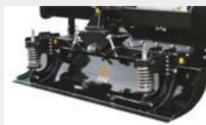
**Cuchilla niveladora (kit de carretera)** para el mantenimiento de carreteras no asfaltadas (STCM - STCM/HP)
